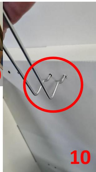
10-Crochet : insérez les crochets en fer par le haut.
